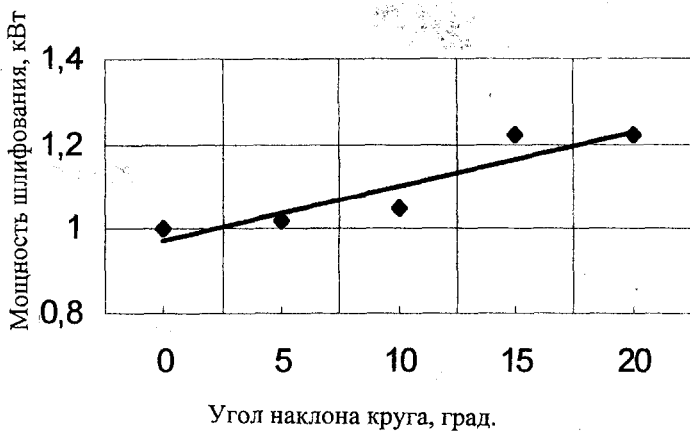
Рис. 3.41. Зависимость мощности шлифования N от угла наклона круга: S = 0,04 м/мин; v_z = 35 м/мин; Z = 12
