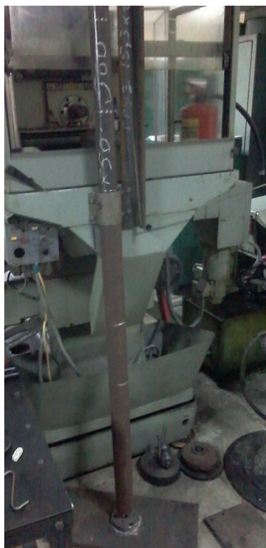
Рисунок 13 - Фотография установки и схема установки для испытания на сопротивление подшипника удару
