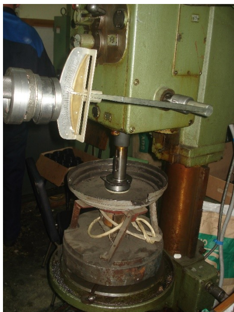
Рисунок 14 – Фотография и схема установки для испытания подшипников на сопротивление ложному бринеллированию
