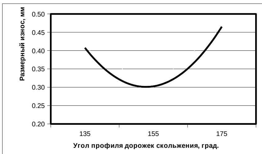
Рисунок 17 – Влияние угла профиля дорожек скольжения на величину износа рабочих поверхностей подшипника
